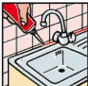
Giunti intorno ai lavelli in acciaio nobile in abbinamento a legno, materiali sintetici o ceramica.
