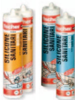
Nella verniciatura, i sigillanti silconici presentano una dilatabilità maggiore di quella delle vernici; questo comporta la rottura successiva dello strato di vernice applicato in superficie nel momento in cui si avrà la dilatazione del giunto. Inoltre le vernici normalmente non aderiscono sui sigillanti silconici, mentre i sigillanti acrilici fischer SA e fischer SAR sono verniciabili con smalti e pitture.
