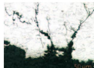
Esempio di corrosione sotto tensione transgranulare sul materiale 1.4401 per l'aggressione di cloruri
