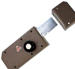
**SERRATURA LATERALE SERIE 3000 con chiave reversibile T200, CILINDRO Ø 34 mm sul lato esterno, POMOLO sul lato interno. Senza scrocco. Corsa catenaccio mm. 78. Dotazione: 3 chiavi art. T200. Disponibile con profilo Italia oppure personalizzato cliente.**
