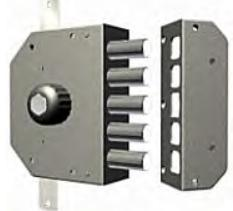
**SERRATURA TRIPLOCE SERIE 3000 con chiave reversibile K55, CILINDRO Ø 29 mm sul lato esterno, POMOLO o CALOTTA sul lato interno. Senza scrocco. Corsa catenaccio mm. 38.**
