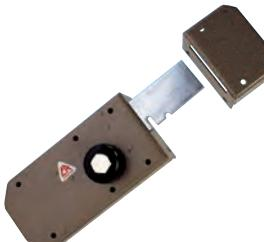
**SERRATURA LATERALE SERIE 3000 con chiave reversibile K55, CILINDRO Ø 34 mm sul lato esterno, POMOLO sul lato interno. Senza scrocco. Corsa catenaccio mm. 78. Dotazione: 3 chiavi art. K55.**
