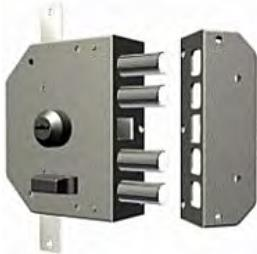
**SERRATURA TRIPPLE SERIE 3000 con cilindro a pompa sul lato esterno, POMOLO o CALOTTA sul lato interno. Con scrocco. Corsa catenaccio mm. 38. Dotazione: 3 chiavi art. 12.**
