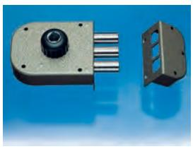
**SERRATURA LATERALE SERIE 1600 con chiave reversibile T200, CILINDRO Ø 29 mm sul lato esterno, POMOLO sul lato interno. Senza scrocco. Corsa catenaccio mm. 38. Dotazione: 3 chiavi art. T200. Disponibile con profilo Italia oppure personalizzato cliente.**
