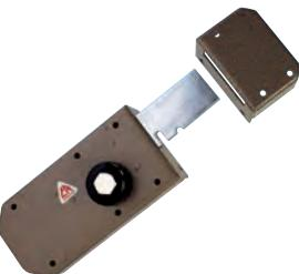
**SERRATURA LATERALE SERIE 3000 con chiave reversibile K55, cilindro Ø 29 mm sul lato esterno, POMOLO sul lato interno. Senza scrocco. Corsa catenaccio mm. 78. Dotazione: 3 chiavi art. K55.**
