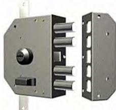
**SERRATURA TRIPLO SERIE 3000 con chiave reversibile brevettata T200, CILINDRO Ø 34 mm sul lato esterno, POMOLO o CALOTTA sul lato interno. Con scrocco. Corsa catenaccio mm. 38. Dotazione: 3 chiavi art. T200. Disponibile con profilo Italia oppure personalizzato cliente. KIT INTERNO.**
