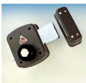
**SERRATURA LATERALE SERIE 1500 con chiave reversibile T200, CILINDRO Ø 34 mm sul lato esterno, POMOLO sul lato interno. Corsa catenaccio mm. 38. Dotazione: 3 chiavi T200. Disponibile con profilo Italia oppure personalizzato cliente.**
