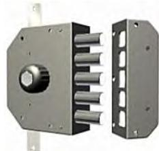
**SERRATURA LATERALE SERIE 3000 con chiave reversibile K55, CILINDRO Ø 29 mm sul lato esterno, POMOLO sul lato interno. Senza scrocco. Corsa catenaccio mm. 38.**
