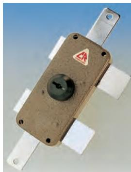
**SERRATURA TRIPLOCE SERIE 230 con chiave reversibile K55, CILINDRO Ø 29 mm sul lato esterno, POMOLO o CALOTTA sul lato interno. Corsa catenaccio/aste mm. 24. Dotazione: 3 chiavi art. K55. KIT INTERNO.**
