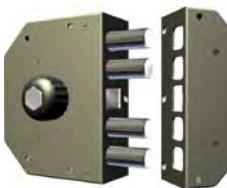
**SERRATURA LATERALE SERIE 3000 con chiave reversibile brevettata T200, CILINDRO Ø 34 mm sul lato esterno, POMOLO sul lato interno. Con scrocco. Corsa catenaccio mm. 38. Dotazione: 3 chiavi art. T200. Disponibile con profilo Italia oppure personalizzato cliente.**
