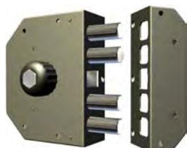
**SERRATURA LATERALE SERIE 3000 con cilindro a pompa sul lato esterno, POMOLO sul lato interno. Con scrocco. Corsa catenaccio mm. 38. Dotazione: 3 chiavi art. 12.**
