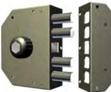
**SERRATURA LATERALE SERIE 3000 con chiave reversibile K55, CILINDRO Ø 34 mm sul lato esterno, POMOLO sul lato interno. Con scrocco. Corsa catenaccio mm. 38.**
