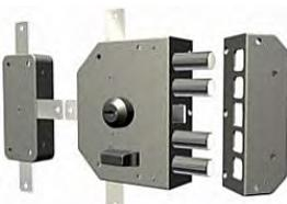
**SERRATURA QUINTUPLA SERIE 3000 con cilindro a pompa sul lato esterno, POMOLO o CALOTTA sul lato interno. Con scrocco. Corsa catenaccio mm. 38. Dotazione: scatola di derivazione, 3 chiavi art. 12.**
