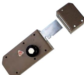
**SERRATURA LATERALE SERIE 3000 con cilindro a pompa sul lato esterno, POMOLO sul lato interno. Senza scrocco. Corsa catenaccio mm. 78. Dotazione: 3 chiavi art. 12.**
