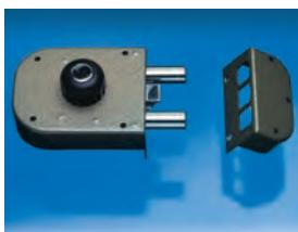
**SERRATURA LATERALE SERIE 1650 con chiave reversibile K55, CILINDRO Ø 34 mm sul lato esterno, POMOLO sul lato interno. Con scrocco. Corsa catenaccio mm. 38.**
