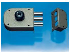
**SERRATURA LATERALE SERIE 1600 con chiave reversibile T200, CILINDRO Ø 34 mm sul lato esterno, POMOLO sul lato interno. Senza scrocco. Corsa catenaccio mm. 38. Dotazione: 3 chiavi art. T200. Disponibile con profilo Italia oppure personalizzato cliente.**
