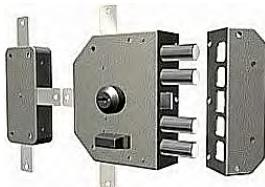
**SERRATURA QUINTUPLA SERIE 3000 con chiave reversibile brevettata T200, CILINDRO Ø 34 mm sul lato esterno, POMOLO o CALOTTA sul lato interno. Con scrocco. Corsa catenaccio mm. 38. Dotazione: 3 chiavi art. T200. Disponibile con profilo Italia oppure personalizzato cliente. KIT INTERNO.**
