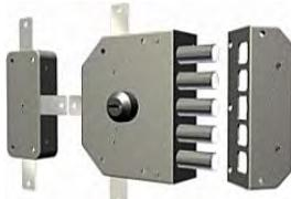
**SERRATURA QUINTUPLA SERIE 3000 con chiave reversibile brevettata T200, CILINDRO Ø 29 mm sul lato esterno, POMOLO o CALOTTA sul lato interno. Senza scrocco. Corsa catenaccio mm. 38. Dotazione: 3 chiavi art. T200. Disponibile con profilo Italia oppure personalizzato cliente. KIT INTERNO.**
