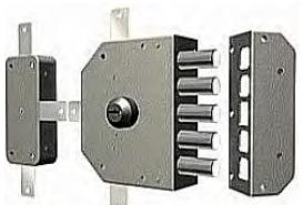
**SERRATURA QUINTUPLA SERIE 3000 con chiave reversibile K55, CILINDRO Ø 29 mm sul lato esterno, POMOLO o CALOTTA sul lato interno. Senza scrocco. Corsa catenaccio mm. 38. Dotazione: 3 chiavi art. K55. KIT INTERNO.**
