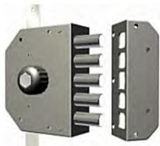
**SERRATURA TRIPLOCE SERIE 3000 con chiave reversibile brevettata T200, CILINDRO Ø 29 mm sul lato esterno, POMOLO o CALOTTA sul lato interno. Senza scrocco. Corsa catenaccio mm. 38. Dotazione: 3 chiavi art. T200. Disponibile con profilo Italia oppure personalizzato cliente. KIT INTERNO.**
