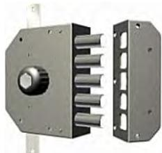
**SERRATURA LATERALE SERIE 3000 con chiave reversibile brevettata T200, CILINDRO Ø 29 mm sul lato esterno, POMOLO sul lato interno. Senza scrocco. Corsa catenaccio mm. 38. Dotazione: 3 chiavi art. T200. Disponibile con profilo Italia oppure personalizzato cliente.**
