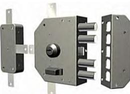
**SERRATURA QUINTUPLA SERIE 3000 con chiave reversibile K55, CILINDRO Ø 29 mm sul lato esterno, POMOLO o CALOTTA sul lato interno. Con scrocco. Corsa catenaccio mm. 38. Dotazione: 3 chiavi art. K55. KIT INTERNO.**
