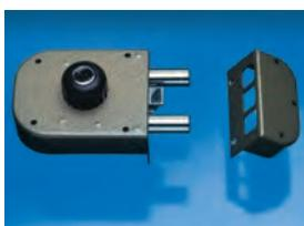
**SERRATURA LATERALE SERIE 1650 con chiave reversibile T200, CILINDRO Ø 34 mm sul lato esterno, POMOLO sul lato interno. Con scrocco. Corsa catenaccio mm. 38. Dotazione: 3 chiavi art. T200. Disponibile con profilo Italia oppure personalizzato cliente.**
