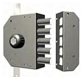
**SERRATURA TRIPPLE SERIE 3000 con cilindro a pompa sul lato esterno, POMOLO o CALOTTA sul lato interno. Senza scrocco. Corsa catenaccio mm. 38. Dotazione: 3 chiavi art. 12.**
