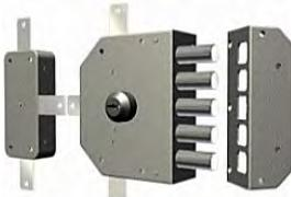
**SERRATURA QUINTUPLA SERIE 3000 con cilindro a pompa sul lato esterno, POMOLO o CALOTTA sul lato interno. Senza scrocco. Corsa catenaccio mm. 38. Dotazione: scatola di derivazione, 3 chiavi art. 12.**
