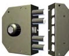
**SERRATURA LATERALE SERIE 3000 con chiave reversibile K55, CILINDRO Ø 29 mm sul lato esterno, POMOLO sul lato interno. Con scrocco. Corsa catenaccio mm. 38.**
