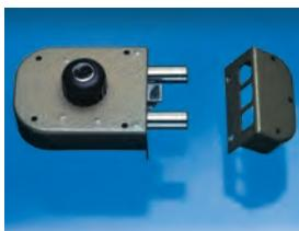
**SERRATURA LATERALE SERIE 1650 con chiave reversibile T200, CILINDRO Ø 29 mm sul lato esterno, POMOLO sul lato interno. Con scrocco. Corsa catenaccio mm. 38. Dotazione: 3 chiavi art. T200. Disponibile con profilo Italia oppure personalizzato cliente.**
