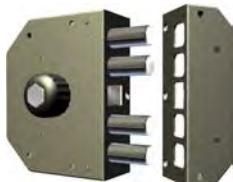
**SERRATURA LATERALE SERIE 3000 con chiave reversibile brevettata T200, CILINDRO Ø 29 mm sul lato esterno, POMOLO sul lato interno. Con scrocco. Corsa catenaccio mm. 38. Dotazione: 3 chiavi art. T200. Disponibile con profilo Italia oppure personalizzato cliente.**
