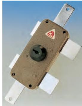
**SERRATURA TRIPLO SERIE 230 con chiave reversibile T200, CILINDRO Ø 29 mm sul lato esterno, POMOLO o CALOTTA sul lato interno. Corsa catenaccio/aste mm. 24. Dotazione: 3 chiavi art. T200. Disponibile con profilo Italia oppure personalizzato cliente. KIT INTERNO.**
