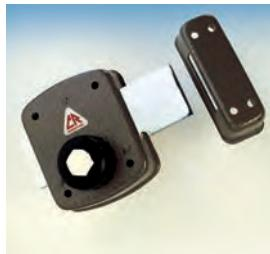
**SERRATURA LATERALE SERIE 1500 con chiave reversibile K55, CILINDRO Ø 29 mm sul lato esterno, POMOLO sul lato interno. Corsa catenaccio mm. 38. Dotazione: 3 chiavi art. K55.**
