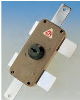
**SERRATURA TRIPLO SERIE 230 con chiave reversibile T200, CILINDRO Ø 34 mm sul lato esterno, POMOLO o CALOTTA sul lato interno. Corsa catenaccio/aste mm. 24. Dotazione: 3 chiavi art. T200. Disponibile con profilo Italia oppure personalizzato cliente. KIT INTERNO.**
