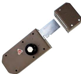
**SERRATURA LATERALE SERIE 3000 con chiave reversibile T200, CILINDRO Ø 29 mm sul lato esterno, POMOLO sul lato interno. Senza scrocco. Corsa catenaccio mm. 78. Dotazione: 3 chiavi art. T200. Disponibile con profilo Italia oppure personalizzato cliente.**
