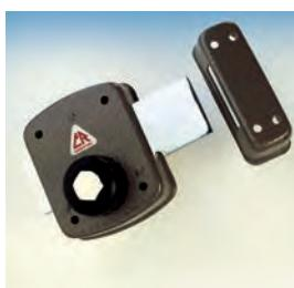
**SERRATURA LATERALE SERIE 1500 con chiave reversibile K55, CILINDRO Ø 34 mm sul lato esterno, POMOLO sul lato interno. Corsa catenaccio mm. 38. Dotazione: 3 chiavi art. K55.**
