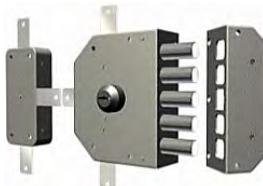
**SERRATURA QUINTUPLA SERIE 3000 con chiave reversibile brevettata T200, CILINDRO Ø 34 mm sul lato esterno, POMOLO o CALOTTA sul lato interno. Senza scrocco. Corsa catenaccio mm. 38. Dotazione: 3 chiavi art. T200. Disponibile con profilo Italia oppure personalizzato cliente. KIT INTERNO.**
