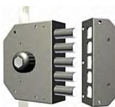
**SERRATURA TRIPLEX SERIE 3000 con chiave reversibile brevettata T200, CILINDRO Ø 34 mm sul lato esterno, POMOLO o CALOTTA sul lato interno. Senza scrocco. Corsa catenaccio mm. 38. Dotazione: 3 chiavi art. T200. Disponibile con profilo Italia oppure personalizzato cliente. KIT INTERNO.**
