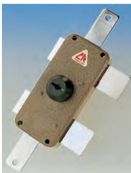
**SERRATURA TRIPLOCE SERIE 230 con cilindro a pompa sul lato esterno, POMOLO o CALOTTA sul lato interno. Corsa catenaccio/aste mm. 24. Dotazione: 3 chiavi art. 12.**
