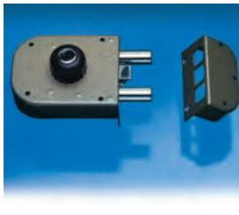
**SERRATURA LATERALE SERIE 1650 con cilindro a pompa sul lato esterno, POMOLO sul lato interno. Con scrocco. Corsa catenaccio mm. 38. Dotazione: 3 chiavi art. 12.**
