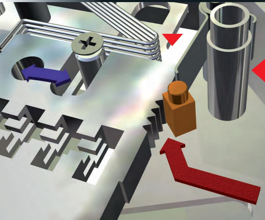
Il dispositivo NO ENTRY è un innovativo sistema di protezione delle serrature a doppia mappa concepito per opporsi ai più recenti metodi di apertura per manipolazione e rappresenta una vera barriera antintrusione.
